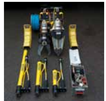
Hilfeleistungssatz mit Spreizer, Rettungsschere und -zylinder, Schwelleraufsatz und Zubehör
